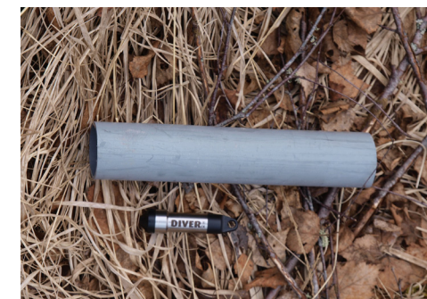
Figure 2-6 : sonde piézométrique et navette de pose.
