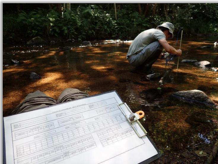
Figure 15. Mesure du potentiel redox à différentes profondeurs de sédiment
