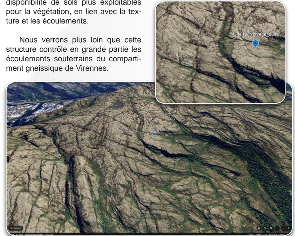
Figure III-2-4 : exemple de fracturation dans des gneiss mis à nue par érosion glaciaire en Norvège. On observe en particulier deux plans de fractures dont un correspond à une foliation majeure de la roche et prend donc une forme ondulée. L'autre, plus classique, est plan.
