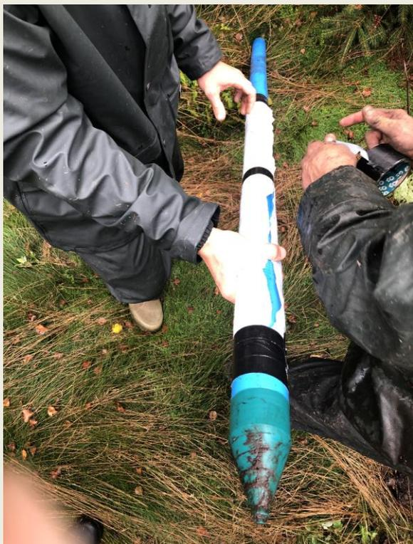
*Sonde installée dans un tube PVC crépiné*
